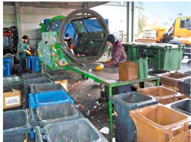
Abb. 2: Abfallanalyse mittels Trommelsiebmaschine
