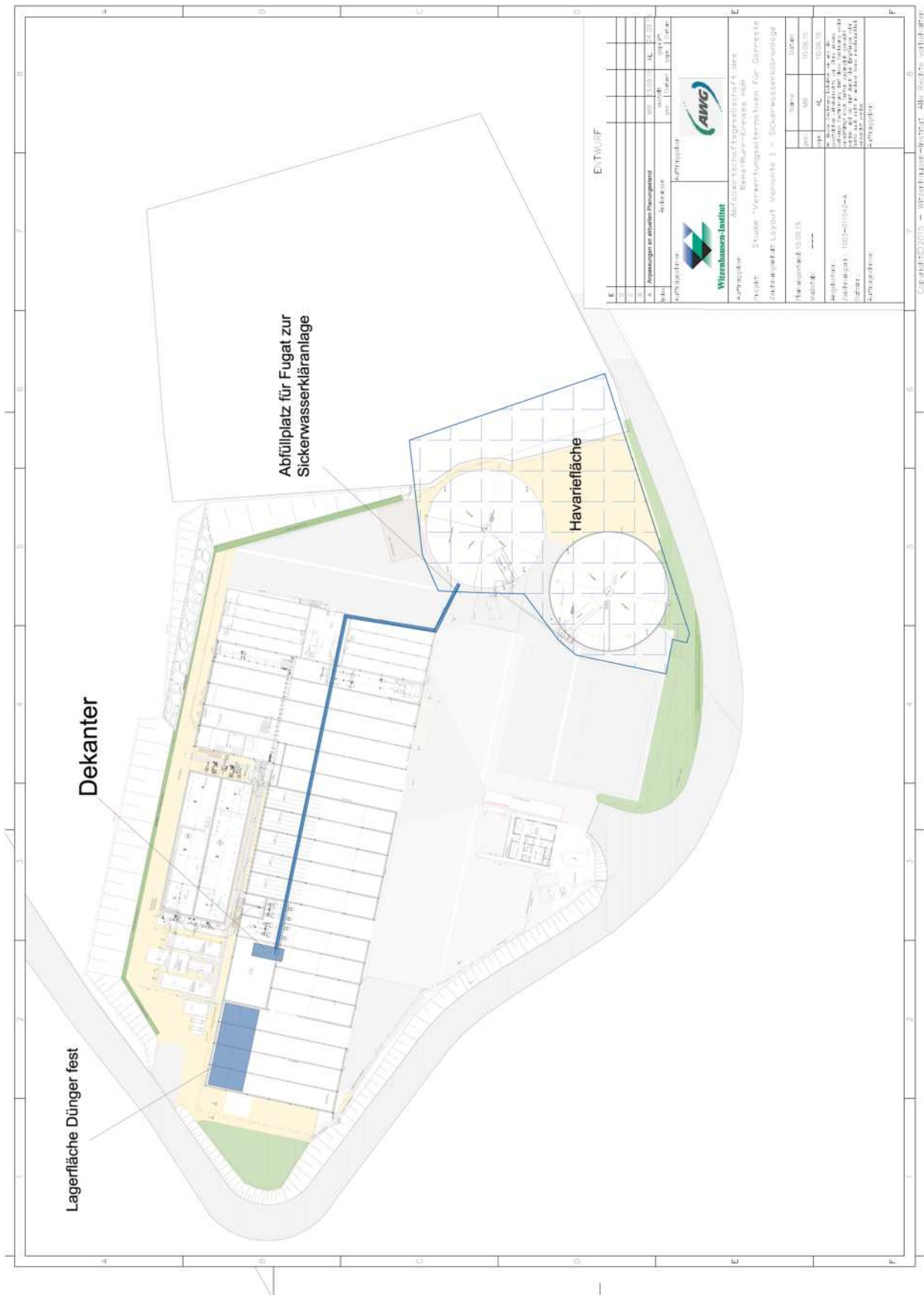
Abb. 30: Aufstellungsskizze zu Variante 1 - Sickerwasserkläranlage
