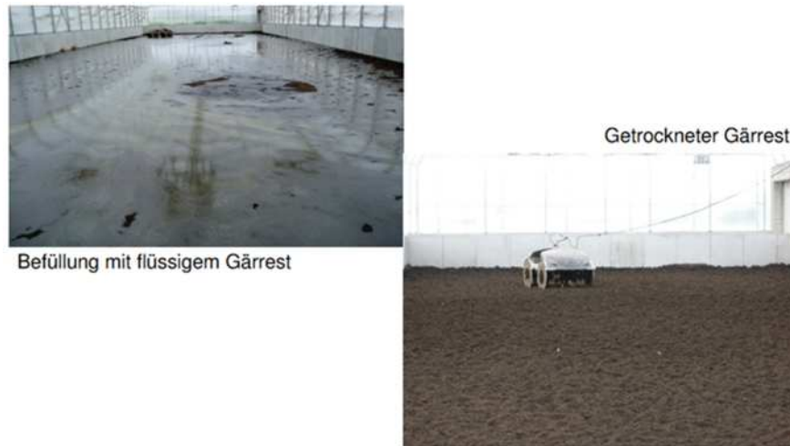
Abb. 24: Befüllung der solaren Trocknung mit flüssigem Gärrest (links) und Bearbeitung mit „elektrischem Schwein“ (rechts); Quelle: Thermo-System
