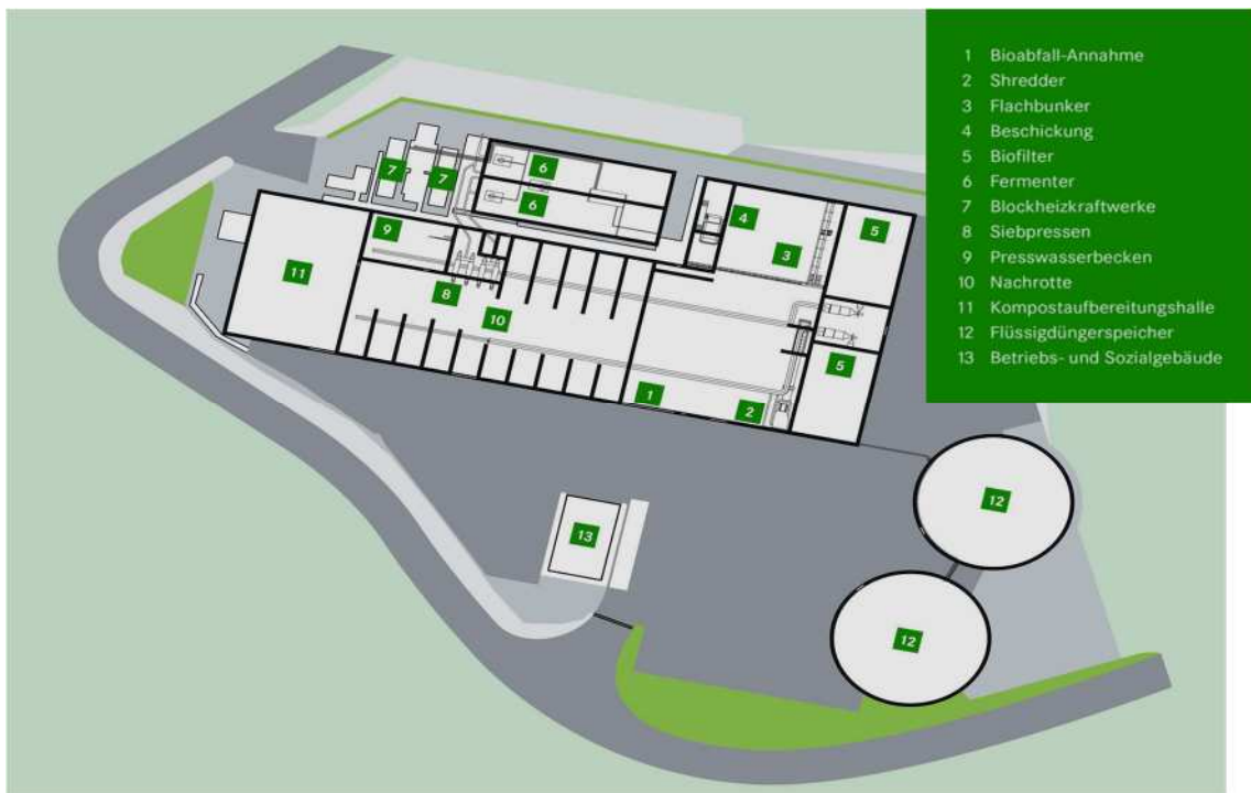
Abb. 2: Luftaufnahme und Funktionsbereiche der Bioabfallvergärungsanlage Backnang (links unten: Gelände des Klärwerks mit Klärschlamm-trocknungsanlage)
