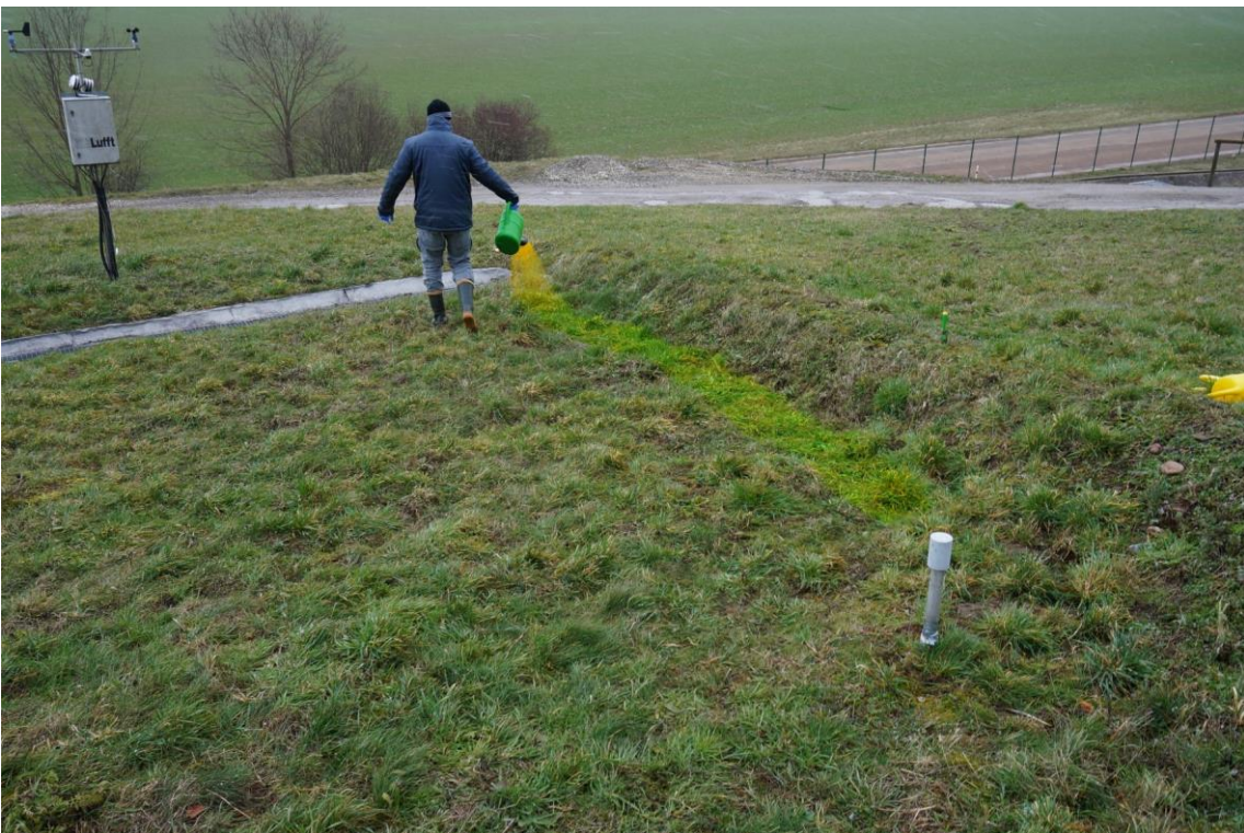
Abbildung 13: Verteilung von Uranin mit einer Gießkanne auf der Lysimeterfläche.
