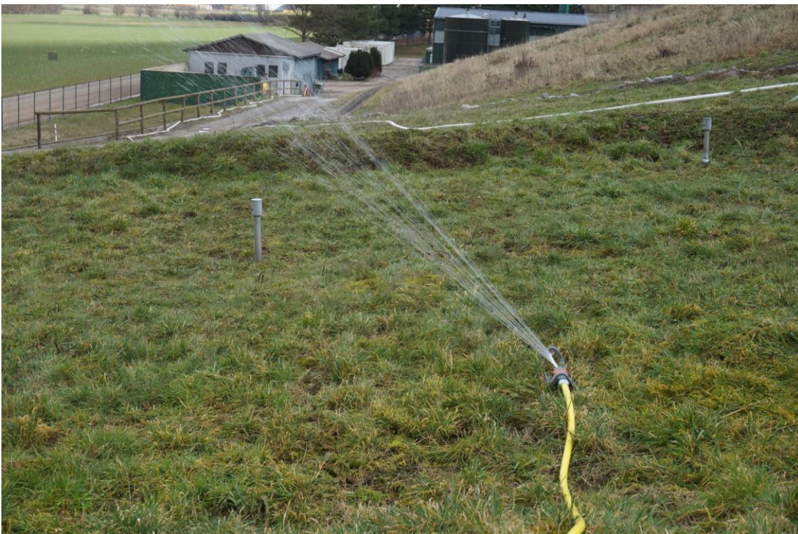
Abbildung 15: Beregnung des Lysimeterfeldes mit einem Gartensprinkler.
