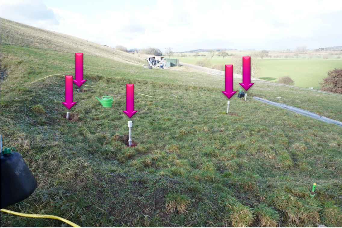
Abbildung 10: Lysimeterfeld mit Lage der Neutronensondenmessstellen und Wassereingabepunkte.
