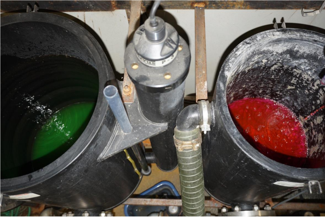
Abbildung 19: Grüne Verfärbung des Oberflächenabfluss und violette Verfärbung des OKF-Abflusses um ca. 17 Uhr am Tag der Eingabe.
