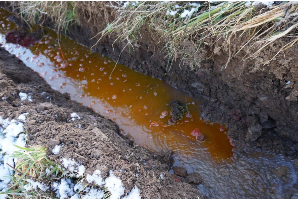
Abbildung 9: Eosin im Baggerschurf oberhalb des Lysimeterfeldes nach der Eingabe. Insgesamt wurden zur Eingabe 408 L Wasser in den Graben gefüllt.
