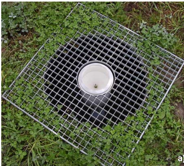
Abb. 3: a) Der Niederschlagsmesser des Lysimeters ist systembedingt direkt am Boden installiert. Die meteorologischen Daten b) werden mit den Niederschlägen an einen Datenlogger im Messcontainer gesendet und online abgerufen.
