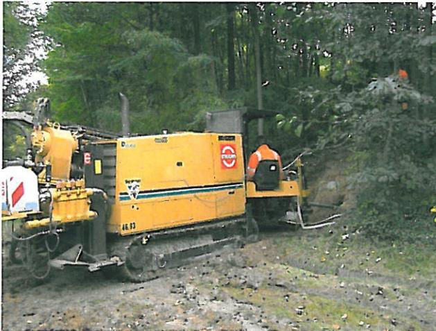
Das Bohrgerät Typ Vermeer D 50X100 wiegt 12,2 Tonnen, es verfügt über eine Raupenkette. Damit sind auch Fahrten in leichtem Gelände möglich. Die Vorschubkraft für das Bohren beträgt 221 kN.
