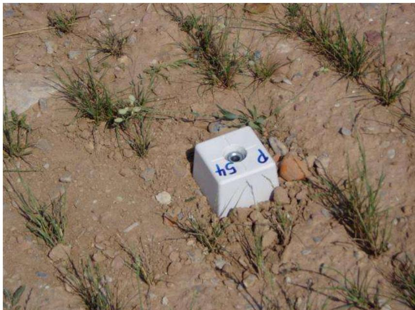
**Bild 24: Setzungspegel auf der Deponie alle 2.500 m<sup>2</sup>**
