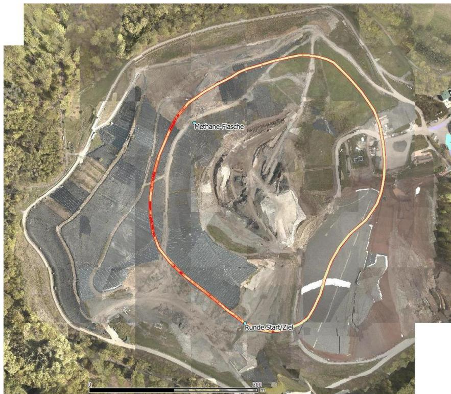
Abb. 29: Methanverteilung bei Fenceline-Flug
