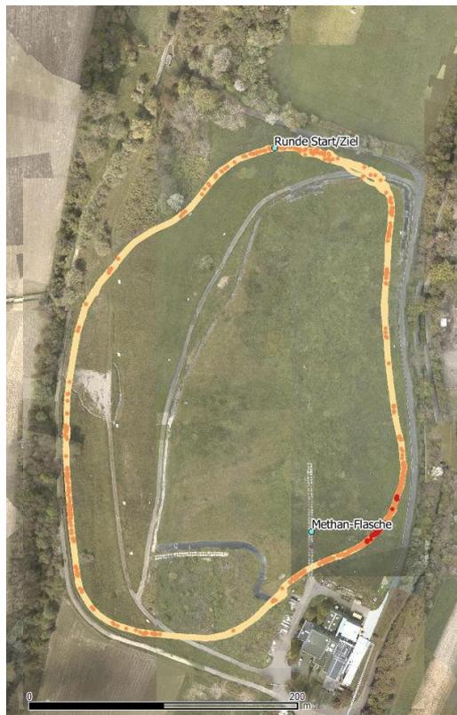
Abb. 10: Methankonzentration (farbcodiert) bei Fenceline-Flug mit geöffneter Gasflasche
