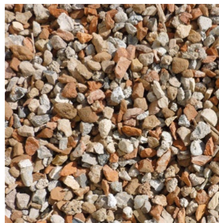
Komponente Mauerwerk für RC-GK Typ 2
