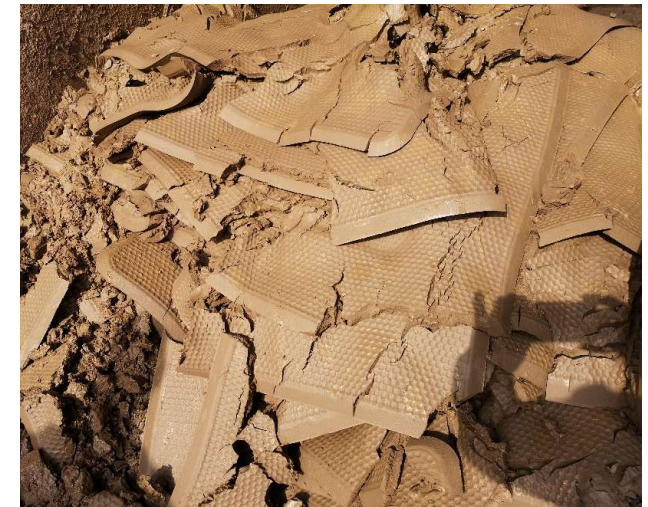
Filterkuchen aus der Kammerfilterpresse < 63 µm
