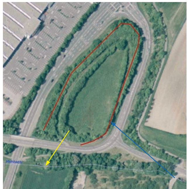
Abb. 4.87: HRB Nr. 15, Rückhalteraum in einem Straßenbogen, blau Einlauf (siehe Abb. 4.81), gelb Auslauf, rot Ringdamm, Sinzheim
