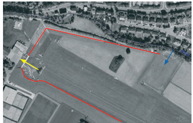
Abb. 4.86: HRB Wiesentalpolder, Stauraum ist ein Segelflugplatz, blau Einlauf (siehe Abb. 4.77), gelb Auslauf (siehe Abb. 4.14), rot Absperredämme / Deiche, Sinsheim
