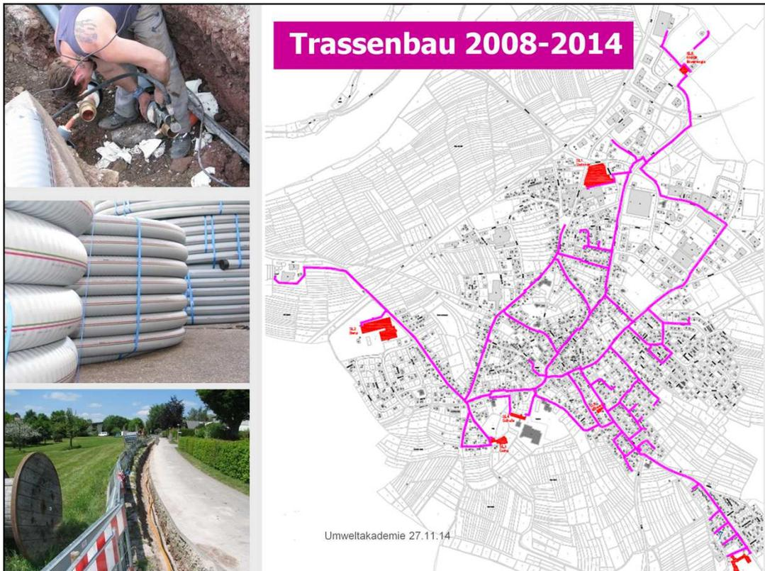
Die Wärmeleitung wurde in den vergangenen 6 Jahren sukzessive ausgebaut. Momentan sind wir mit 13,5km Hauptleitungen und 8,5km Hausanschlussleitungen bereits bei fast 22 km Leitungslänge.
