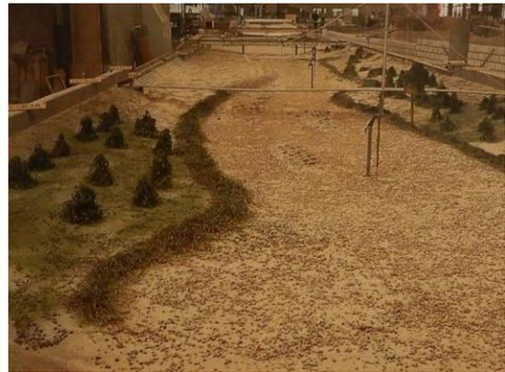
**Bild 9: Modellversuch zur Umgestaltung der Enz im Flussbaulabor der TU Karlsruhe**
