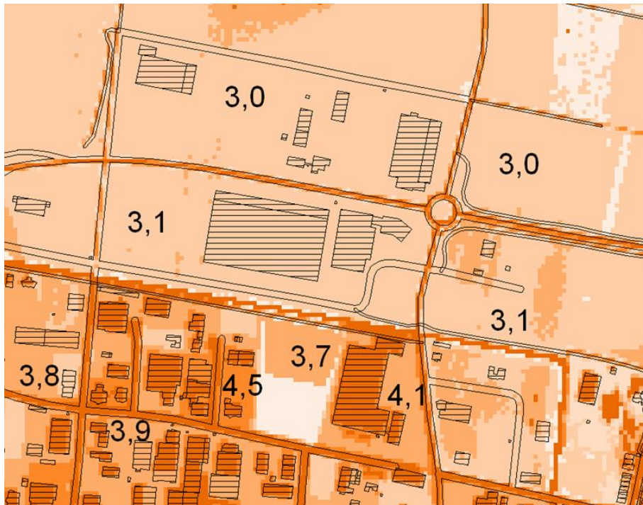
Abbildung 3: OAK-Werte [mm/5 min] auf den Grundstücken um die alte Bebauung und auf den Flächen, auf denen neue Gebäude errichtet wurden.
