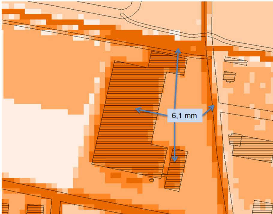
**Abbildung 2:** Teilausschnitt aus Abbildung 1. Zu erkennen sind die Übergangsbereiche an den Gebäuden und Straßen, die die Mittelwerte aus den vollversiegelten und nur teilweise oder gar nicht versiegelten Nachbarflächen abbilden. Zur Übertragung auf neu hinzugekommene Gebäude- und Straßenflächen sollten die Werte aus dem Zentrum der schon vorhandenen Geometrien verwendet werden, hier 6,1 mm.
