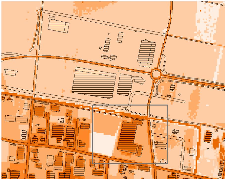
**Abbildung 1:** Beispiel der OAK-Verteilung für einen 5-Minuten-Zeitschnitt (orange bis weiß) überlagert mit der aktuellen Lage von Gebäuden (schraffiert), Straßen (breite Umrandung) und Wegen (schmale Umrandung). Das graue Rechteck markiert den in Abbildung 2 dargestellten Bereich.
