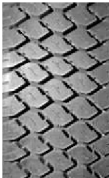
Bild 12: Profil eines Nutzfahrzeugreifens für Antriebsachsen (Traktionsprofil) [27]
