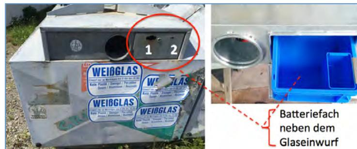
**Abb. 2** Depotcontainer zur Sammlung von Hohlglas im Zollernalbkreis ausgestattet mit zusätzlichem Batteriefach (1) für Rund/Flachzellen und (2) für Knopfzellen (Foto: Scheffold)
