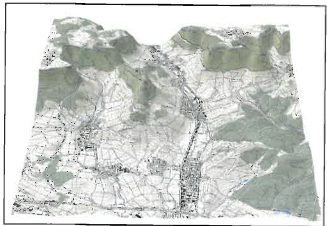
Abb. 1.6: Kombination eines digitalen Höhenmodells und einer Topographischen Karte
