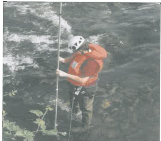
Abb. 1.13: Vermessung eines Gewässerprofils.
