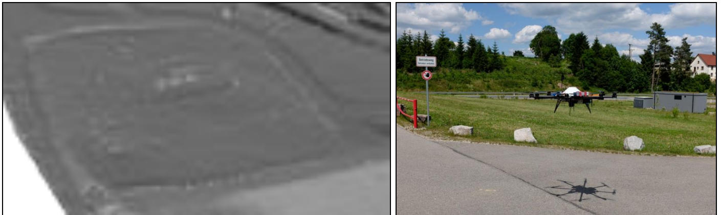
Abbildung 6 & 7: in der Schummerungsdarstellung der Punktwolke sind selbst die den Straßenbereich begrenzenden Steine eindeutig erkennbar.
