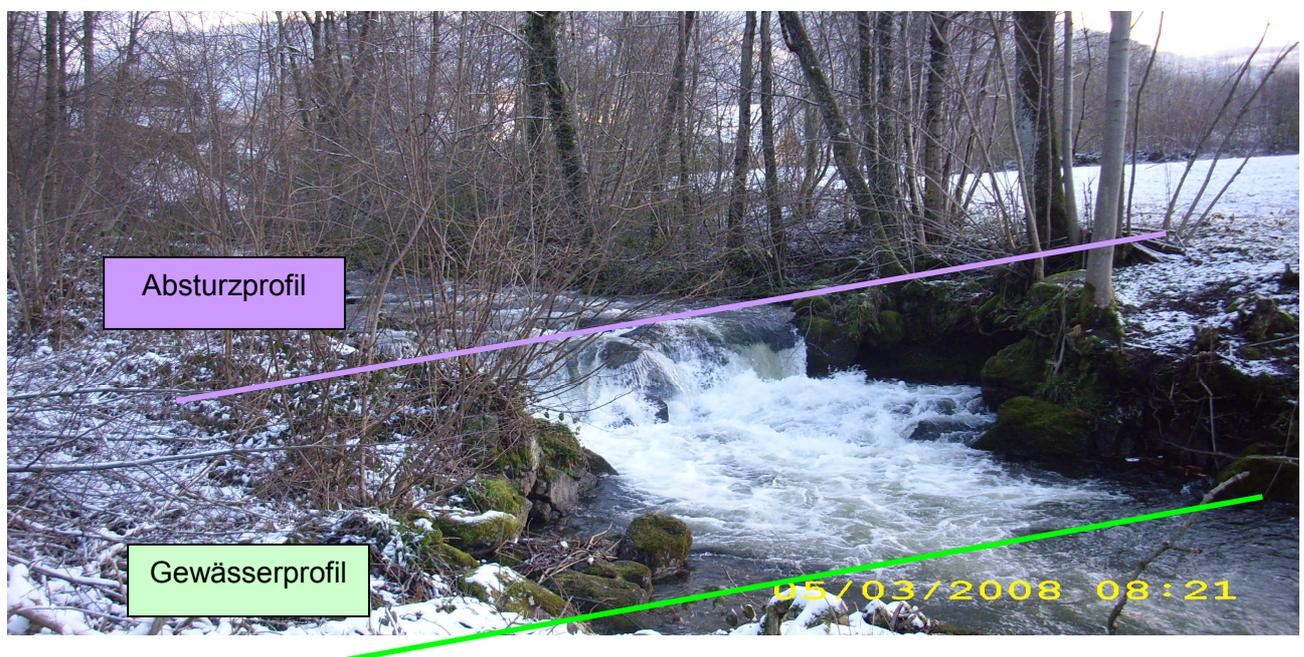
Bei kaskadenförmiger Sohle genügt die Aufnahme der Querprofile an markanten Abstürzen (mindestens am ersten und letzten Absturz), also jeweils an der Überfallkante. Auf weitere Gewässerprofile zur Ermittlung der Absturzhöhe kann, bis auf die Aufnahme eines Gewässerprofils am Ende der Kaskade) in einem solchen Fall verzichtet werden.
