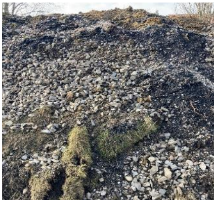
Schluffiges Ausgangsmaterial mit Störstoffen
