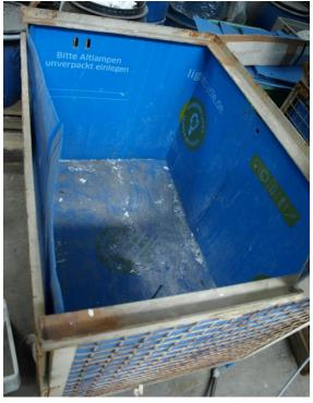
Darüber hinaus konnte mit einem direktanzeigenden Quecksilbermessgerät (Hg MAK 1200) am Boden von ausgetauschten Gitterboxen eine Quecksilberkontamination von bis 800 µg/m³ festgestellt werden. Eine Verschleppung von Quecksilber durch feine ESL-Glasbruchteile in den Austausch-Sammelboxen ist wahrscheinlich. Um dies zu vermeiden, sollte in Erwägung gezogen werden, zukünftig die Gitterboxen vor Neuauslieferung zu reinigen bzw. mit einer Einwegfolie auszulegen.
