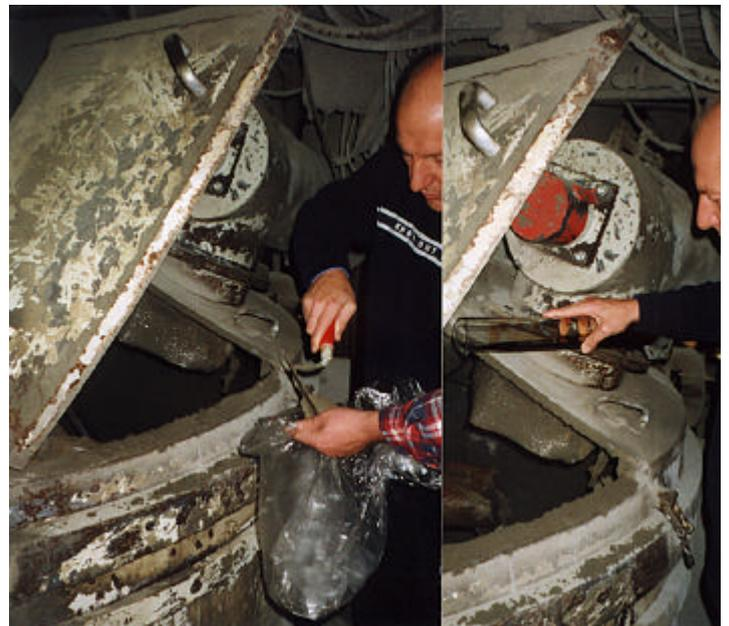
Abb. 11: Dosierung des Chromatreduktionsmittels und Probenahme am Zwangstellersmischer
