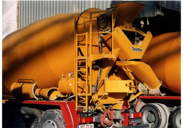
Abb. 13: Fass für Betonzusatzmittel am Betonmischfahrzeug
