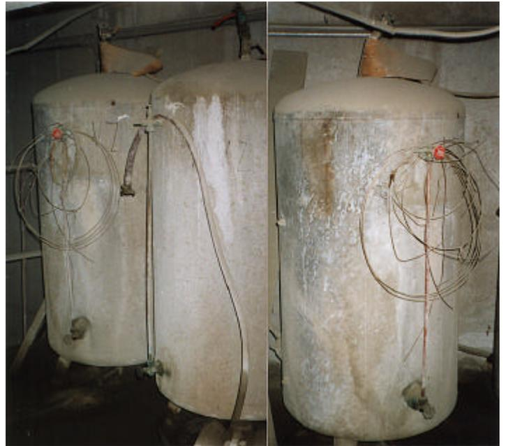
Abb. 12: Fässer mit Anschlussapparaturen für die Zugabe von Betonzusatzmitteln
