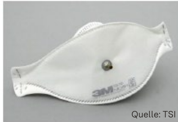
Prüfling mit Sondenanschluss
