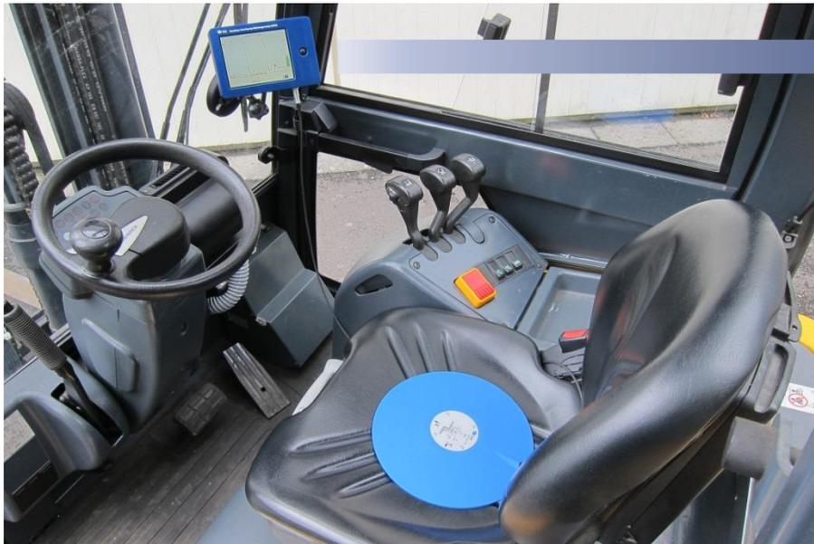
Die Schwingungsbelastungen werden dem Bediener angezeigt. (Bild: IFA)
