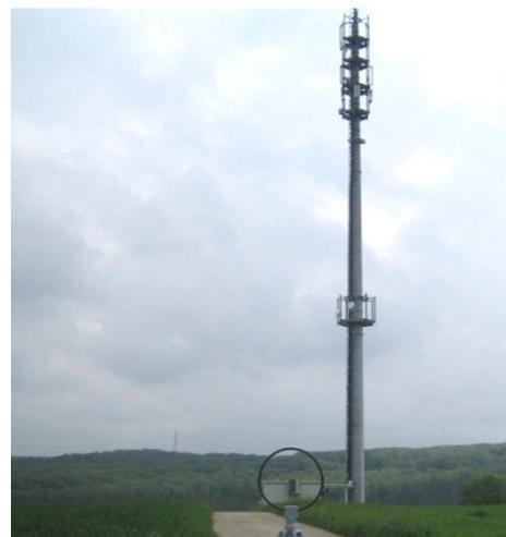
Abb. 2: Messaufbau vor Mobilfunkmast (Messpunkt 2450)
