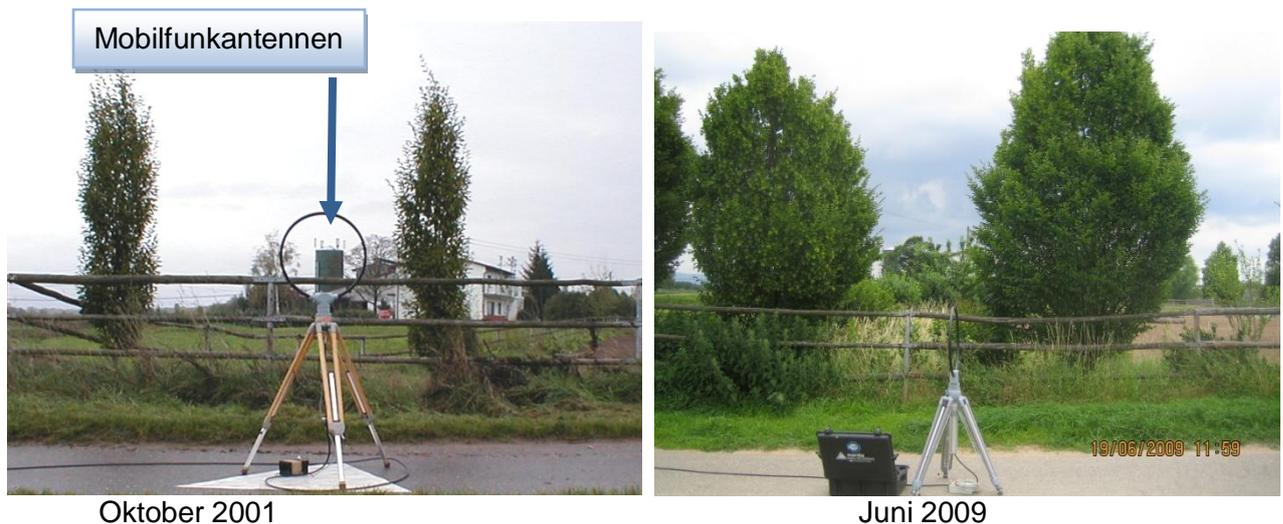
Abb. 59: Sichtverbindung zu Mobilfunkanlagen auf dem Silo wird am Messpunkt 1050 im Raum Schwetzingen mittlerweile durch gewachsene Büsche und Bäume verdeckt
