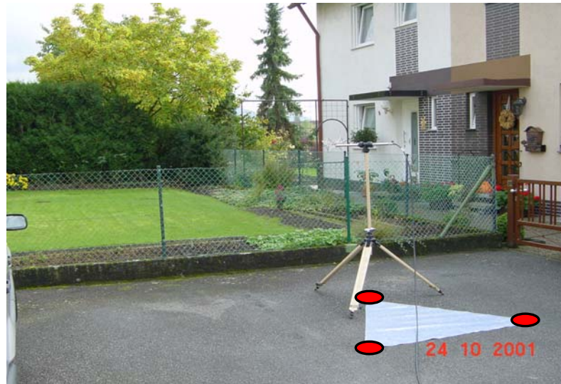
Abb. 2: Typischer Messaufbau (Rot: 3 Messpunkte, an den Ecken eines gleichseitigen Dreiecks mit 1,5 m Kantenlänge)
