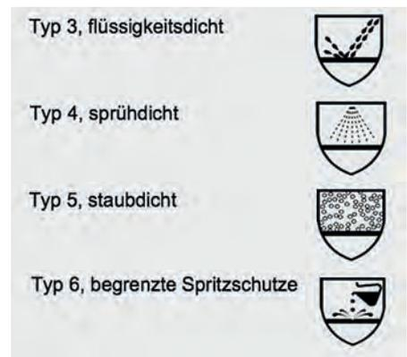
Abb. 2: Typenbezeichnungen für Chemikalienschutzanzüge
