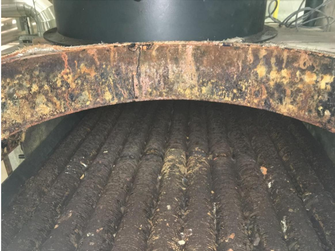
**Taupunkt-Unterschreitung:** Korrosion und Verschmutzung des Economisers. Kondensiert das Abgas und das bei der Verbrennung entstehende Wasser bilden sich Säuren.
