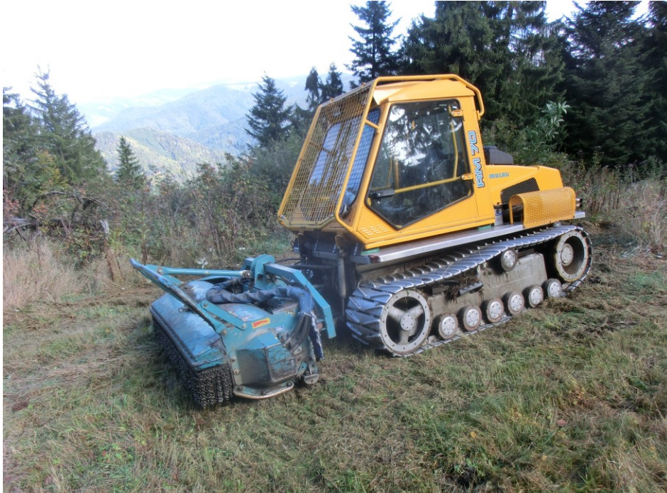
Bild 37: Zur Weidepflege in Extensivweiden eingesetzte Mulchraupe
