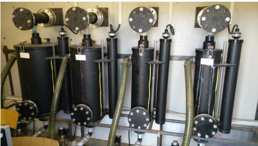
Abbildung 2 Auffangbehälter der vier Abflusskomponenten im Lysimeterhaus. Die Proben zur Analyse werden direkt an den Abflüssen oberhalb der Behälter genommen.
