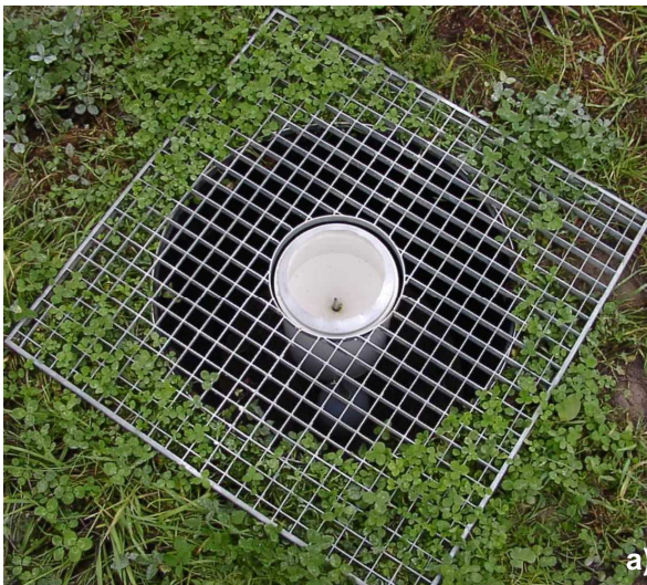
Abb. 4: a) Der Niederschlagsmesser des Lysimeters ist systembedingt direkt am Boden installiert. b) Die weiteren meteorologischen Daten werden mit den Niederschlägen an einen Datenlogger im Messcontainer gesendet und online abgerufen.
