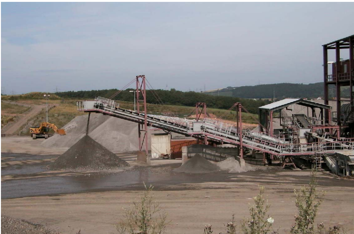
Abb. 15: Aufbereitungsanlage mit Abtrennung der unterschiedlichen Kornfraktionen
