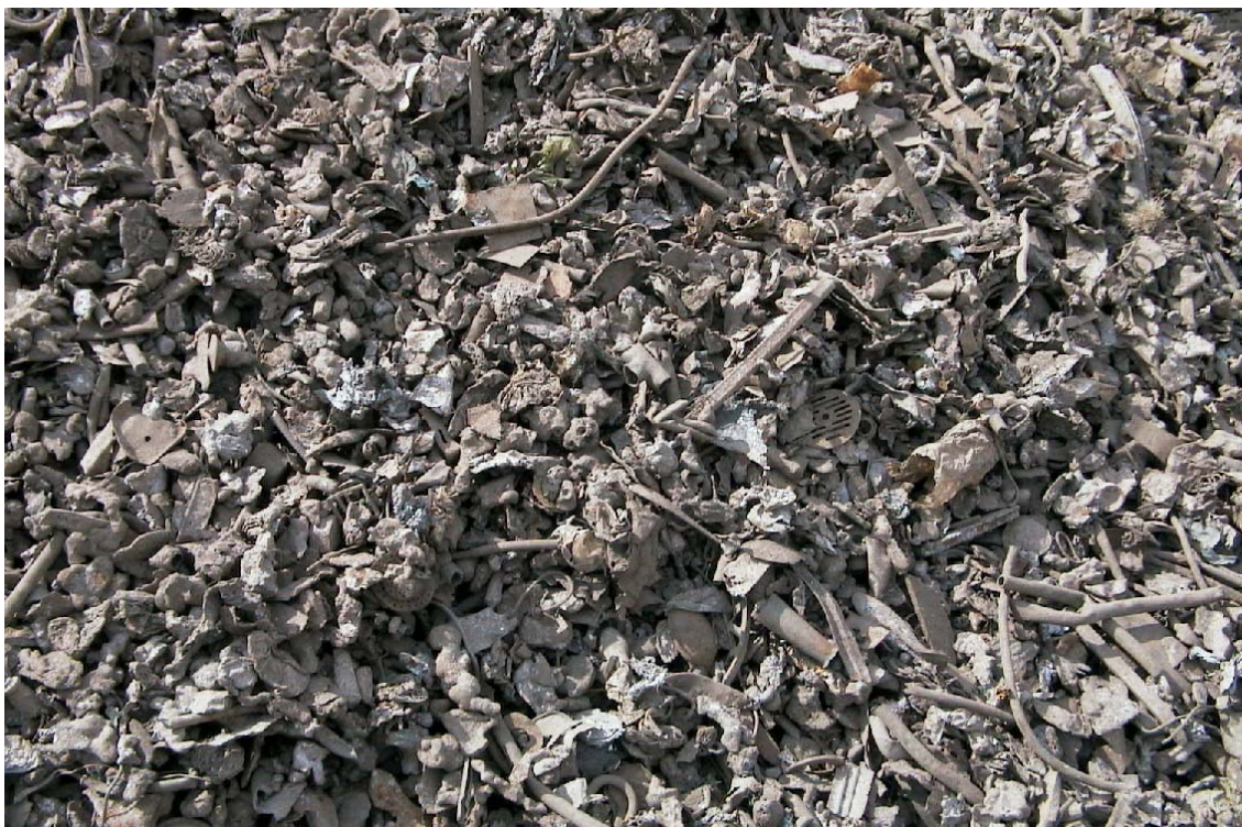
Abb. 17: Aus der Schlacke abgeschiedenes Nichteisenmetall
