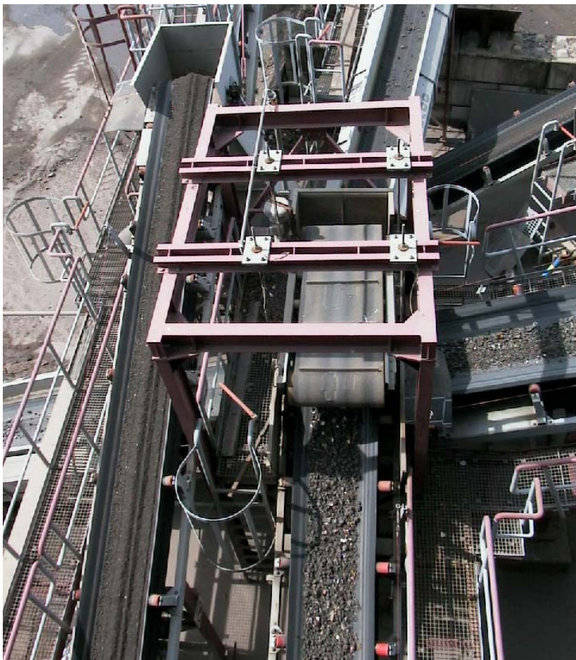
Abb. 16: Überbandmagnet für die Eisenabscheidung
