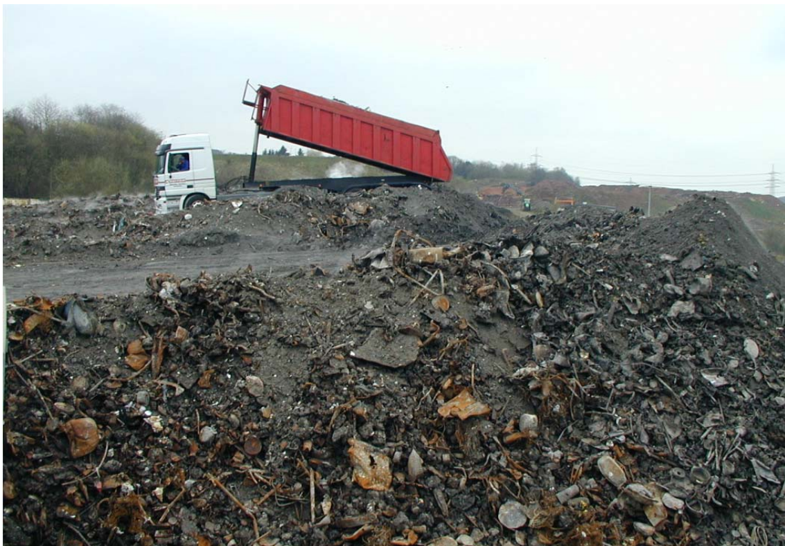
Abb. 8: Anlieferung von Rohschlacke in der Aufbereitungsanlage
