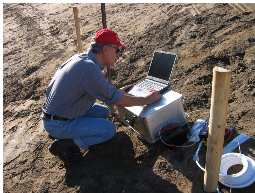
Bild 8: Kontrollmessungen unmittelbar nach dem Verlegen der Sensoren
