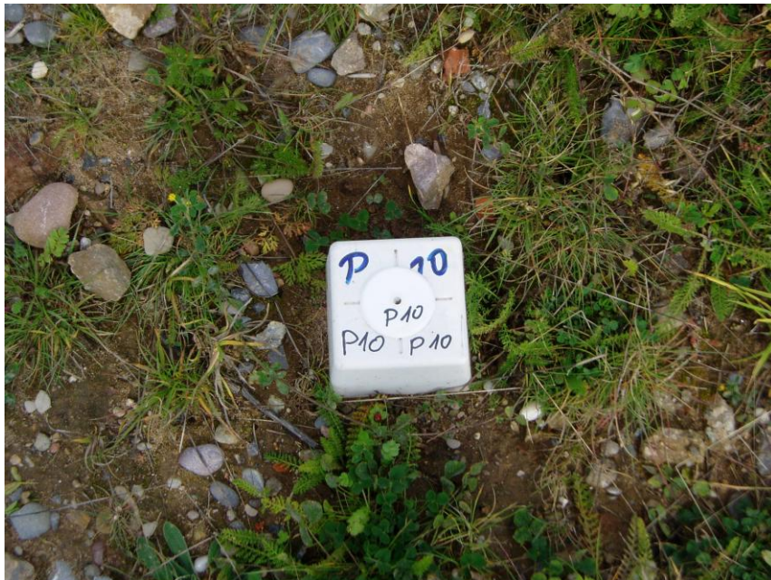
Bild 8: Hergestellte Setzungspegel auf der Deponieoberfläche
