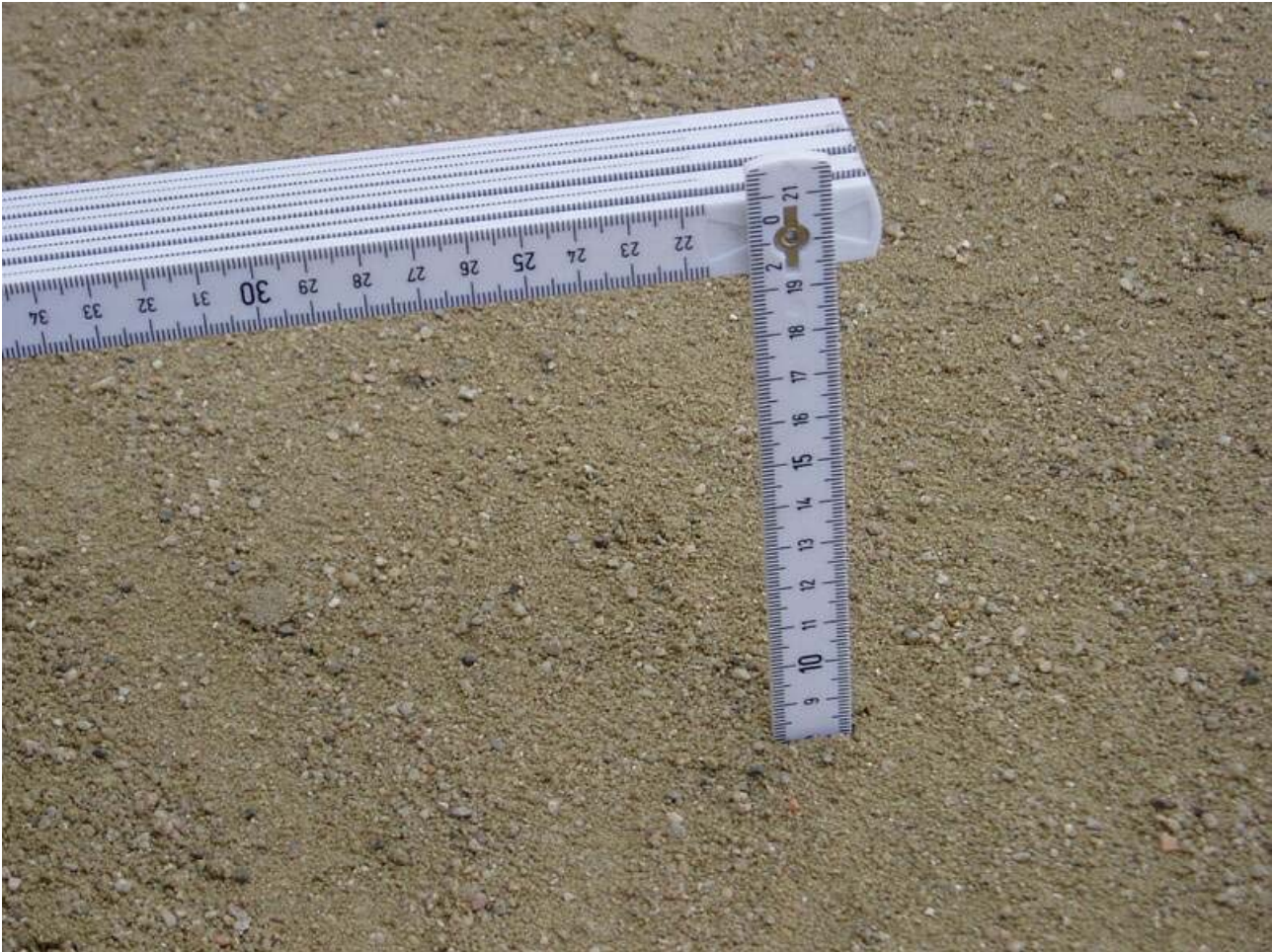
Bild 9: Überprüfung der Schichtdicke des Trisoplastes
