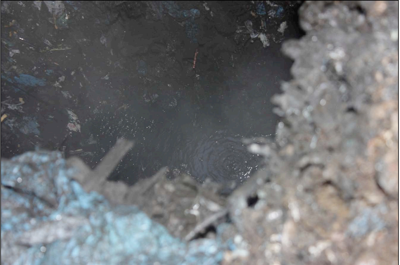
Abbildung 6 In das Bohrloch BS2 fließendes Sickerwasser
