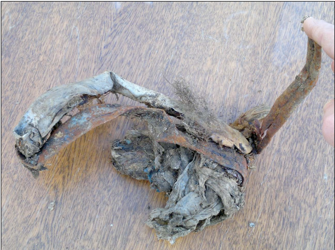
Abbildung 11 Deformiertes Metallrohr mit Störstoffen
