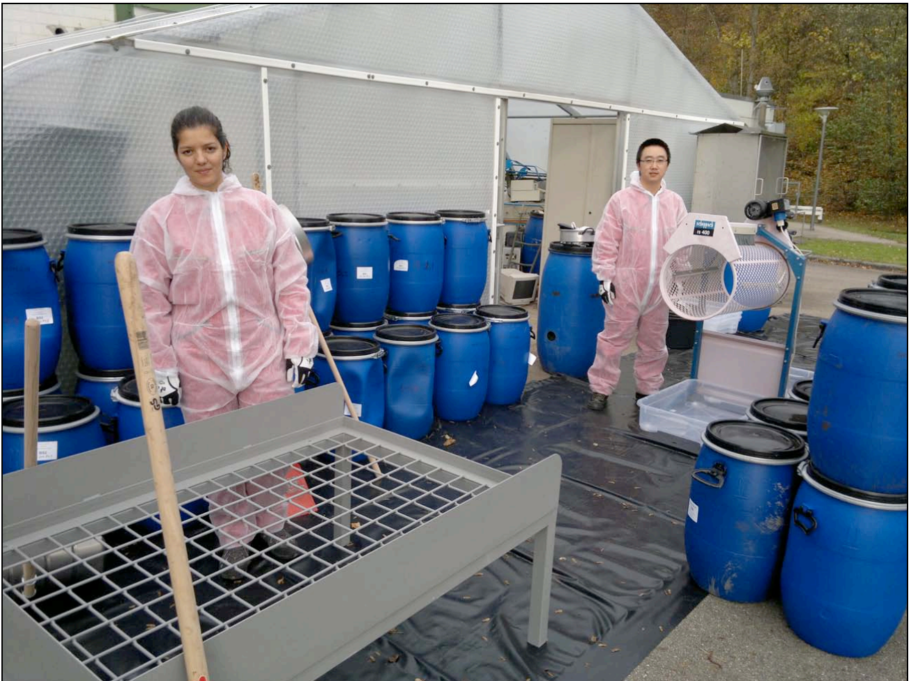
Abbildung 8 Durchwurfsieb, Maschenweite 80 mm und Trommelsieb, Lochgröße 20 mm
