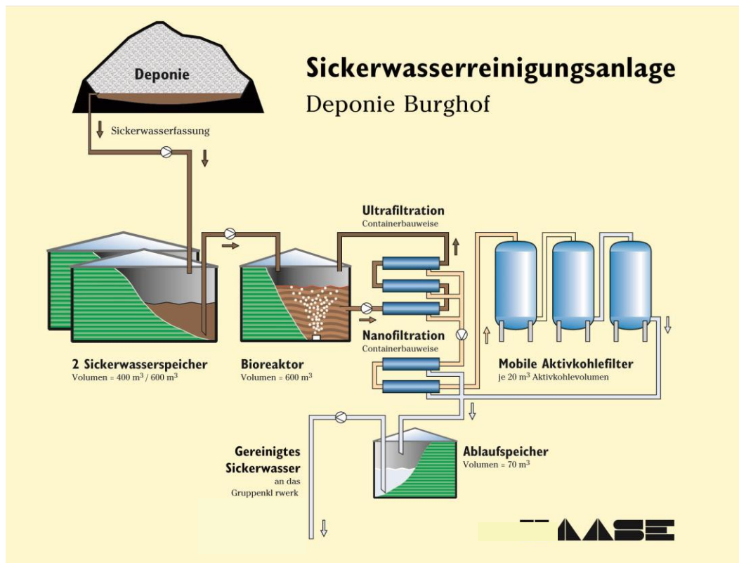
Abbildung 2: Verfahrenstechnik der SRA Deponie Burghof (Firma Haase)
